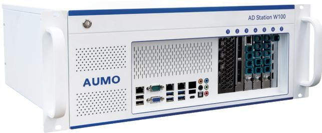
AD Station W100 是自动驾驶车辆采集计算、硬件在环仿真测试 HIL 测试系统的理想选择，配备 Intel 至强 Gold5317，12 核 24 线程，内存最大可扩展 4T DDR4，支持双显卡，支持最高 112 路视频采集，16 路视频数据注入回灌以及视频采集注入一体功能等自动驾驶 HIL 仿真需求。
